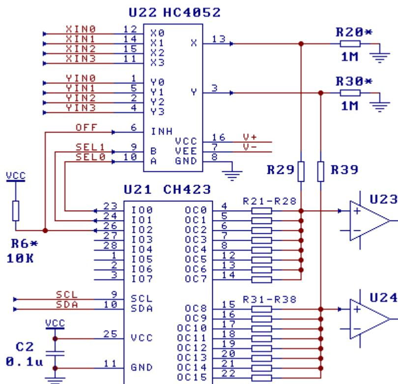
CH423 的 OC 引脚在开漏输出方式下是低阻开漏输出，导通电阻小于 10 欧姆，可以用作一端接地的模拟开关，多个 OC 引脚各自外接电阻并组合导通后，可以构成一端接地的数字可编程电阻。
